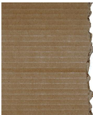
El cartón corrugado está formado por la unión de tres papeles, los cuales se denominan: el externo tapa o cara, el intermedio onda y el interno contratapa o contratara. Este tipo de corrugado con una sola onda corresponde al denominado “simple onda” es el material comúnmente utilizado en todo tipo de envases.
