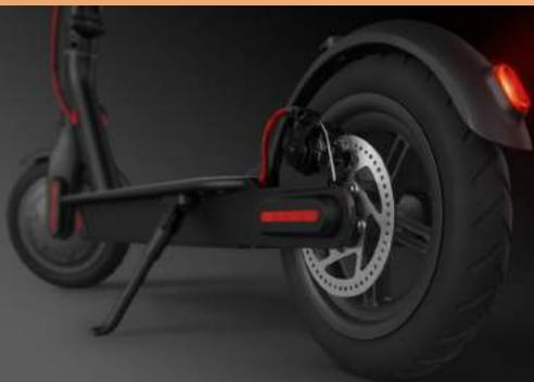
Una ejemplo en escala pequeña es este mono patín eléctrico diseñado con un sistema de recuperación de la energía cinética. Es decir, el movimiento de una de las ruedas está vinculado a un generador que recarga o devuelve algo de energía a la batería. ¡Incluso la energía que surge de cada frenada también se almacena!
